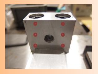
測定が完了したら、座標測定機の「白:次 へ」ボタンを押す。 11.以上で測定は終了である。画面右下の「レポート表示」をクリックする。
