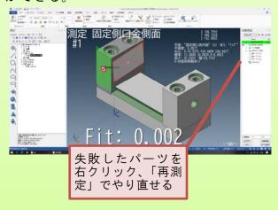
7. 下の画面が表示されたら、固定側口金内面の測定を行う。
