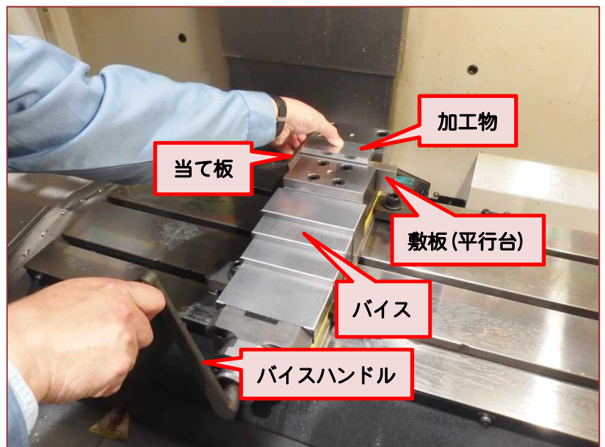
図2 加工物の固定
