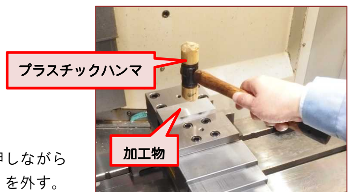
図3 プラスチックハンマーで叩く
