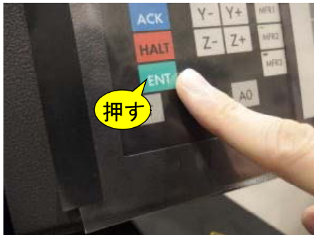
②⑦ [ENT]スイッチを押すと加工が開始される
