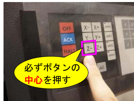
⑥約15mmの高さまで[Z-]スイッチの中央部分を徐々に押す。
