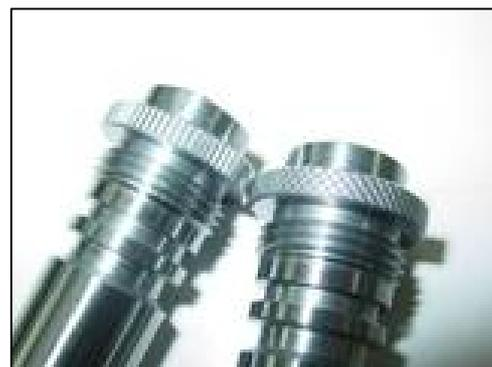
○ローレット加工は旋盤で行う通常の切削加工とは異なり、ダイス（駒）を被削材に強く押し当てて塑性変形させる「**転造**」加工で、非常に大きな力が加わる。そのためローレットは刃物台にしっかりと装着し、刃物台も強くロックすること。
