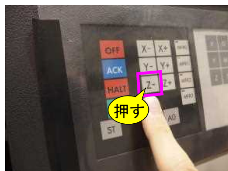
⑧約2mmの高さまで[Z-]スイッチを徐々に押す。
