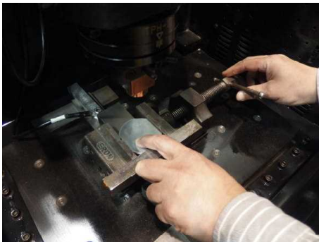
② [押さえ]の円弧部を当て板に当てバイスを手で締める
